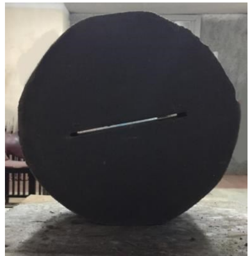
Рисунок 3.2 – Изготовленная модель бетонной облицовки с повреждением в виде сквозной шероховатой трещины
