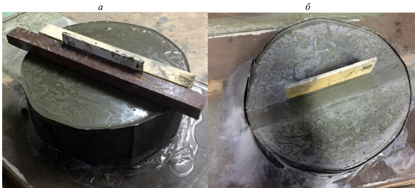
Рисунок 3.3 – Изготовление испытываемого образца бетонной облицовки с повреждением в виде трещины
