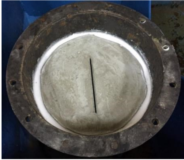
Рисунок 3.4 – Установка испытываемого образца бетонной облицовки канала со сквозной трещиной
